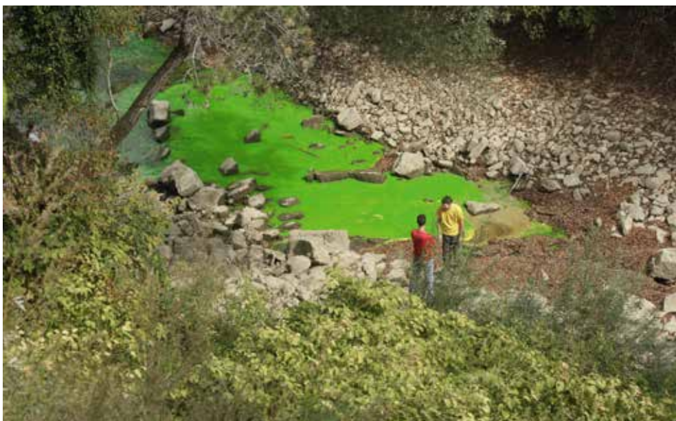
Slika 3.6.3: Vremski požiralnik. Sledilni preizkus s fluorescentno zelenim barvilom (uraninom) (foto: arhiv Oddelka za matematiko in geoznanosti Univerze v Trstu (DMG))
