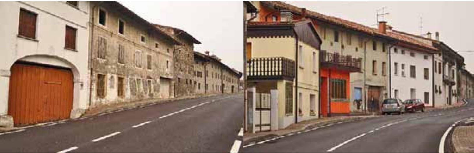
Fig. 1 e fig. 2. Immagine di insediamento molto compatto; la cortina sul fronte strada, rivolta a est nord-est, presenta la tipica successione degli androni d'accesso alle corti interne. Nella foto di sinistra appare ben conservata anche l'originale forometria nonché la tessitura muraria in ciottoli, tipica di questa zona, frutto dell'approvvigionamento del materiale da costruzione sul greto dei torrenti e, soprattutto, su quello molto ampio del fiume Tagliamento. La leggera strombatura della muratura in basso dimostra, accentuandolo, il carattere di insediamento fortificato. Nella seconda immagine sono evidenti le incursioni recenti contro l'omogeneità della cortina, date da superfetazioni successive per ricavare maggiori spazi abitativi o accessi più comodi. Foto di Laura Di Bidino.
