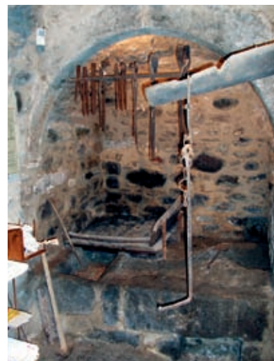
Il fusinâl con in primo piano la musse indispensabile per sostenere ed appoggiare i pezzi lunghi in lavorazione nella fucina.
