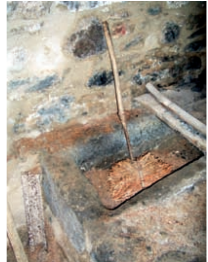
La vascje , ricavata da un unico blocco in pietra, riempita d'acqua serviva per immergere la vadule utilizzata per mantenere bagnata la terra attorno al borastai .
