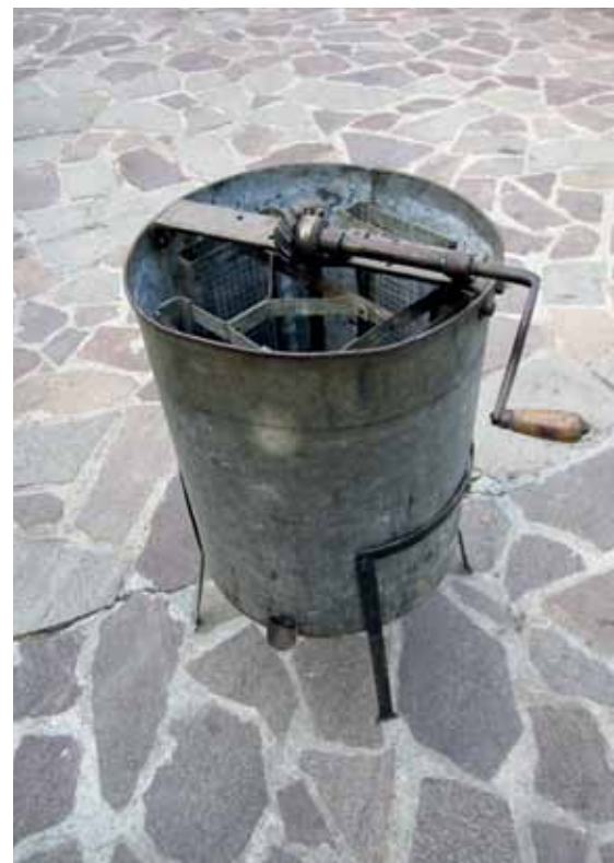
Vecchio smielatore, costruito negli anni Venti del secolo scorso da Giacomo Ferigo ( Jaconàt , classe 1883), utilizzando materiale di recupero proveniente dal fronte (l'ingranaggio della centrifuga ad esempio è stato preso da un carro). L'attrezzo veniva utilizzato dall'apicoltore omonimo Giacomo Ferigo ( Jacun da Sule ) di Ravinis (foto Giulia Nascimbene).
